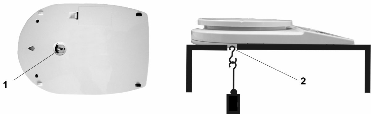
Abb. 1: Einrichten der Waage für Unterflurwägungen
