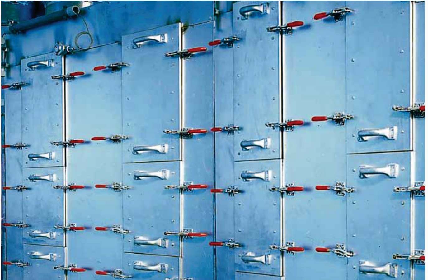
Handspannereinsatz, z.B. im Anlagenbau: Zuverlässigkeit und lange Lebensdauer zeichnen diese AMF-Handspanner ganz besonders aus. Abbildung: Waagrechtspanner Nr. 6830.
