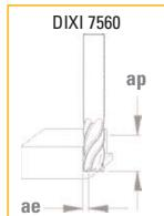
$$n \text{ [tr/min]} = \frac{Vc \text{ [m/min]} \times 1000}{\pi \times D_1 \text{ [mm]}}$$
