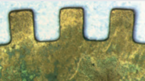
Oxidación en una rueda dentada
