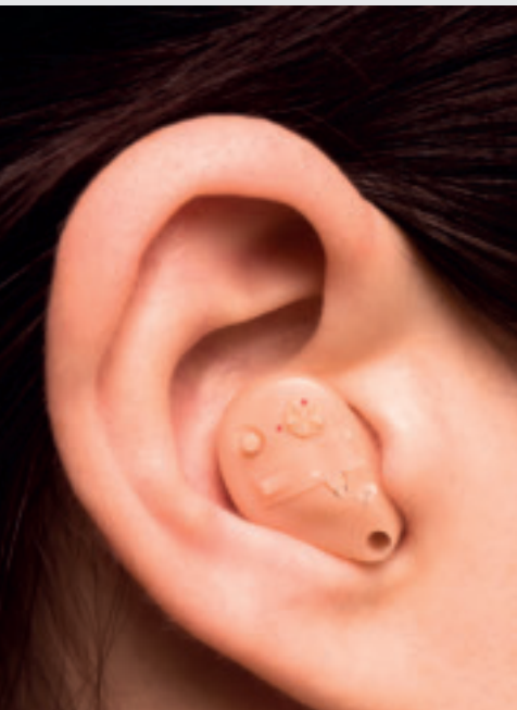
Buen ejemplo de miniaturización extrema: moderno audífono
