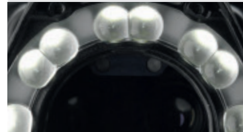
Las lentes de enfoque del anillo de luz optimizan el brillo y la iluminación
