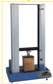
Computergesteuerter Prüfstand MultiTest 10-i mit Lastzelle 10 kN und Druckplatte 130 mm². Banc d'essais informatisé Multitest 10-i et capteur ILC-S 10kN avec plateau de compression rectangulaire 130 mm².
