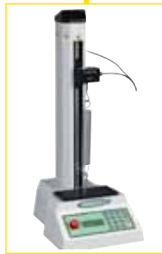
Konsolengesteuerter Prüfstand MultiTest 5-x mit Lastzelle 5000 N und Sonderdruckplatte Ø 50 mm. Banc d'essais programmable Multitest 5-x et capteur XLC-S 5000 N avec plateau de compression ventilé Ø 50 mm.
