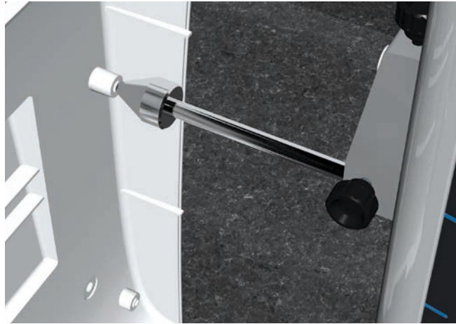
Medida de la distancia entre ejes en una carcasa de plástico de una caja electrónica
