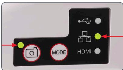
3. Si un modo que no sea el de HDMI está iluminado en verde, pulse el interruptor de modo y espere hasta que tanto el LED de estado como el panel de modo HDMI dejen de parpadear.
