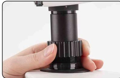
3. Coloque la unidad en la salida para vídeo/fotografía del microscopio estereoscópico y atorníllela.
