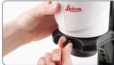
2. Gire el portaóptica lateralmente hasta la posición deseada.
