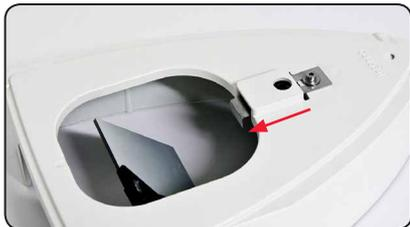
3. Coloque el estativo de episcopía sobre la base para diascopía y encájelo con el tornillo de unión.
