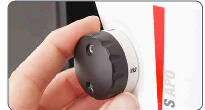
2. Para el ocular ajustable, gire la corrección de dioptrías hasta la posición central.
