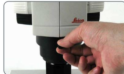
2. Coloque el portaóptica en el soporte y oriéntelo de modo que la ranura del portaóptica y el tornillo aprisionador situado debajo del mismo queden alineados.
