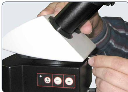
5. Apriete el tornillo de orientación con precaución, sujetando el tubo ligeramente. Así, el tubo se coloca automáticamente en la posición correcta.
