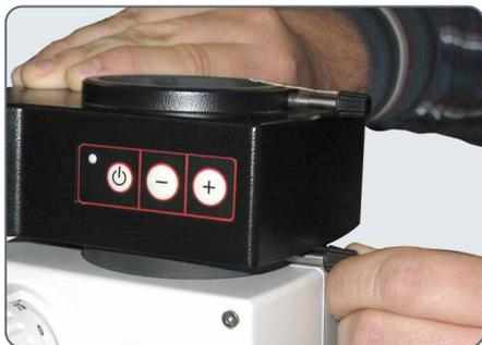
4. Inserte el tubo (p. ej., el tubo binocular inclinado) en el orificio anular y gírelo ligeramente hacia ambos lados hasta que el tornillo de orientación encaje en la ranura guía.
