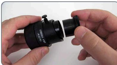
4. Ahora puede orientar el retículo girando el ocular dentro del tubo y, a continuación, fíjelo con el tornillo apriionador.
