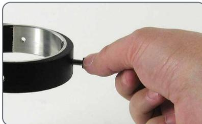
2. Reapriete el tornillo aprisionador situado debajo del portaóptica.
