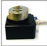
Para montar en un banco o integrado en un sistema de ensayos. Se suministra con cuadradillo macho de arrastre para montaje fácil de adaptadores.
