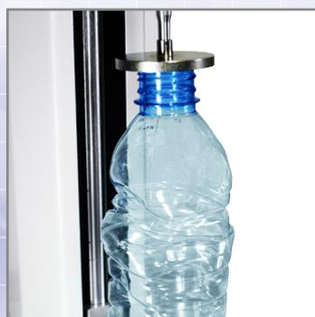
Ensayo de Top-load
