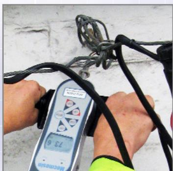
Ensayo de tracción en punto de anclaje
