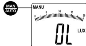
Premere il tasto „MAN/AUTO“ fino a che è impostato il relativo campo di misura manuale o fino a che sul display appare „AUTO“ ed è nuovamente impostato il campo manuale.
