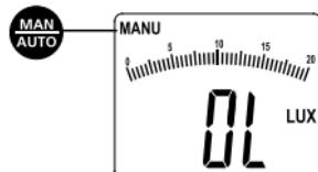
pomiarowym, to na wyświetlaczu ukazuje się „OL”. Należy nacisnąć przycisk „MAN/AUTO” aż do nastawienia odpowiedniego zakresu pomiarowego bądź do ukazania się na wyświetlaczu komunikatu „AUTO” i ustawienia automatycznego zakresu pomiaru.
