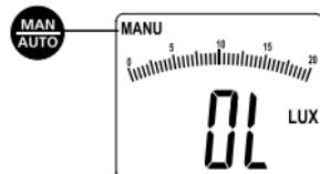
Pulse la tecla „MAN/AUTO” hasta que esté ajustado el rango de medición manual correspondiente, o bien se visualice en la pantalla „AUTO” y esté ajustado de nuevo el rango automático.
