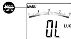
Druk op de toets ‚MAN/AUTO’ totdat het betreffende handmatige meetbereik ingesteld is of totdat ‚AUTO’ op het display verschijnt en het automatische meetbereik weer is ingesteld.
