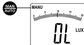
Drücken Sie die Taste „MAN/AUTO“ bis der entsprechende manuelle Messbereich eingestellt ist bzw. bis „AUTO“ im Display erscheint und der automatische Messbereich wieder eingestellt ist.
