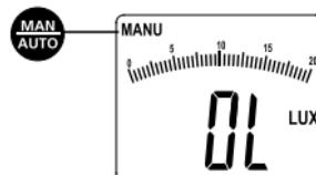
medição, no visor aparece "OL". Carregue na tecla "MAN/AUTO" até a margem de medição manual correspondente estar ajustada ou até "AUTO" aparecer no visor e a margem de medição automática voltar a estar ajustada.
